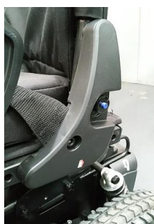
Proteção para o encosto quando a cadeira tem o sistema DAHL //QJR090164
